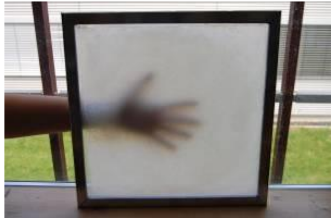
Abbildung 1: Links: Simulation des Durchgangs einer elektromagnetischen Welle durch eine regelmäßige Struktur. Rechts: Lichttransmission durch eine transluzente Wärmedämmung.
